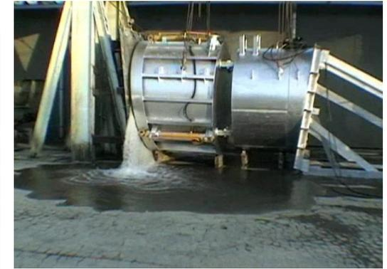
【説明4】 工場漏水・加圧試験
