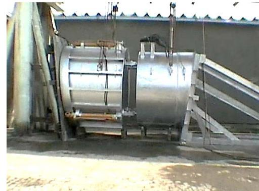
【説明3】 工場漏水・加圧試験
